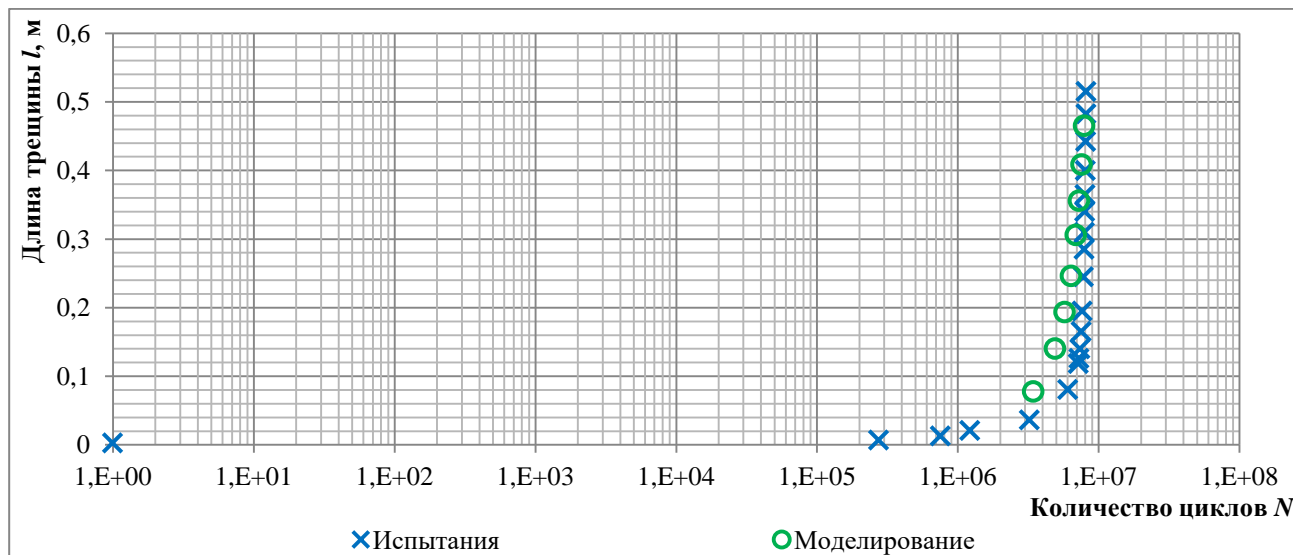
Рисунок 3.18 – Диаграмма зависимости количества циклов нагружений до достижения критической длины трещины цельнокатаного колеса
