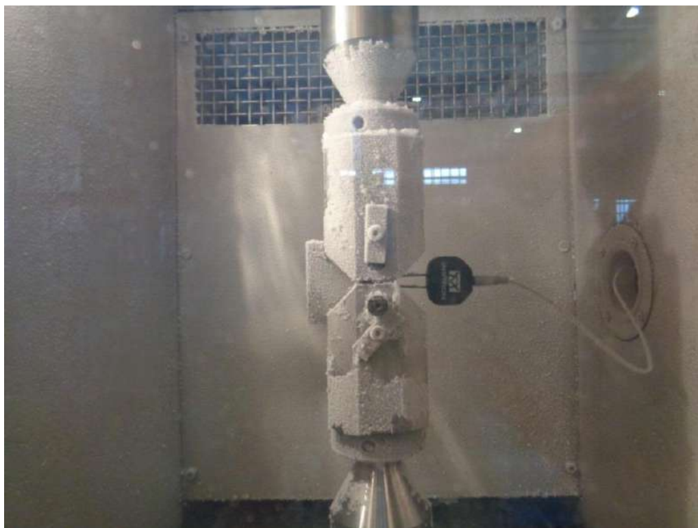
Рисунок 3.7 – Испытываемый образец на рабочем столе системы для измерения параметров испытаний в климатической камере при минус 60°С
