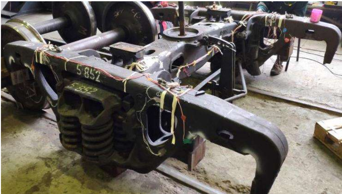
Рисунок 4.7 – Подготовка тележки вагона и наклейка тензорезисторов
