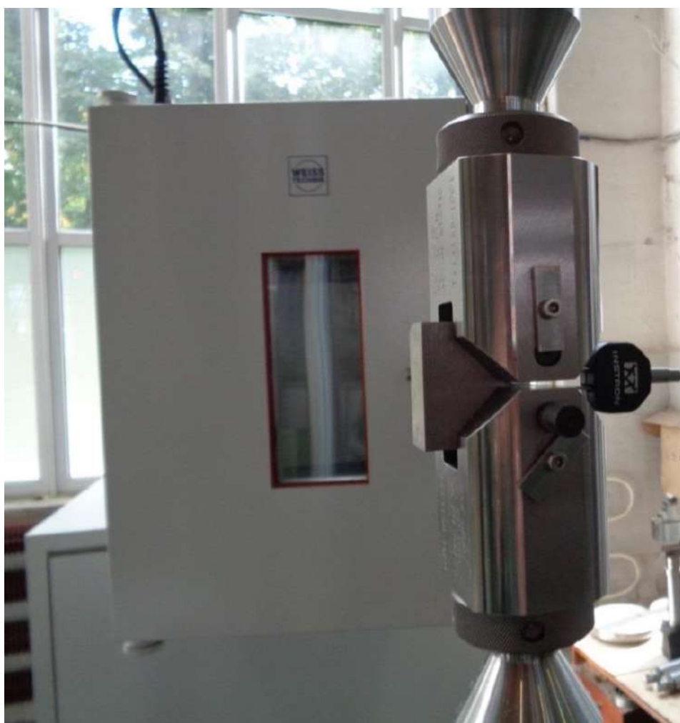
Рисунок 3.6 – Вид системы для измерения параметров испытаний с образцом при комнатной температуре
